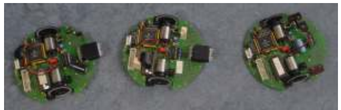
Cyclopes en 1994, processeur HC11 et caméra linéaire
