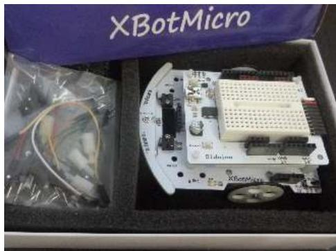
Le Diduibot est livré dans une boîte contenant des composants électroniques et des fils pour câbler des Leds, résistances, transistors, photo-résistances, et apprendre à gérer ces éléments. Il est livré programmé avec un évitement d'obstacle simple; 8 fils à ajouter et mettez le Xbot dans une arène. Il se déplace rapidement et ses moustaches sont très efficaces. Avec l'accu chargé il roulera plus d'une heure!
