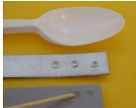
On transporte une microgoutte de colle vers la zone à coller le plus efficacement avec une herbe sèche de 1mm de diamètre, taillés en biseau par un coup de pince ou de lame de rasoir. Le tube de l'herbe joue un peu le rôle de réservoir et avec la pointe du biseau, on peut toucher l'endroit précisément.
