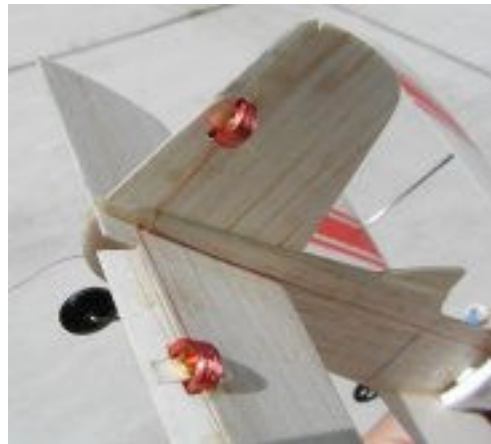
Fig. 5 Aimant fixé à la gouverne (construction Ralph Bradley)
