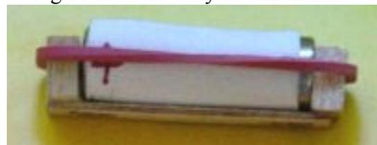
Fig 12 Bloc de 3 accu NiCd 70 mAh
