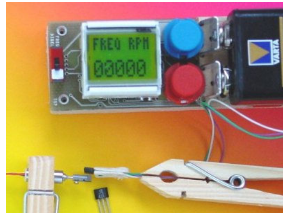
Fig 2. Lecture de la vitesse de rotation à vide sur un moteur 4mm (aimant 2x2mm et capteur 4905)
