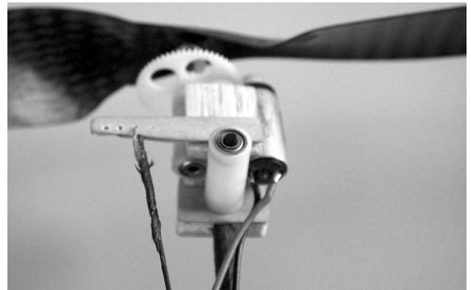
Figure 5 – Système de propulsion orientable
