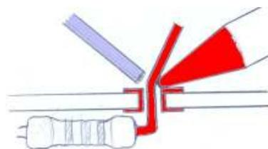
On doit voir la soudure fondre et se répartir quand on pousse 1 à 2 mm de fil à souder.
