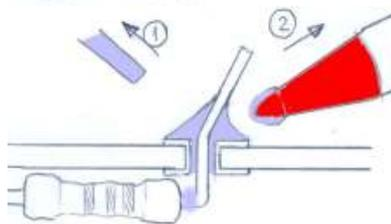
Ce qu'il ne faut pas faire, c'est chauffer le fil et pas assez la pastille. Il faut alors rechauffer et amener un peu de soudure à cause du flux qui dedans (du flux suffirait le cas de la photo, on voit y a assez de soudure)
