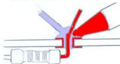
On retire la soudure d'abord, et une fraction de seconde plus tard, le fer à souder. On doit voir que la soudure a mouillé le fil et la pastille, avec une forme de volcan et pas de goutte.
