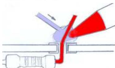
L'autre erreur est de ne chauffer que la pastille et de croire qu'avec une plus grosse goutte de soudure cela sera bon. La soudure ne monte pas le long du fil et le contact n'est pas fiable (soudure froide).
