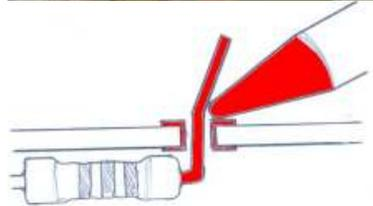
Approcher la soudure dans l'angle chaud, si la soudure touche le fer, cela doit être à sa pointe où elle touche le fil.
