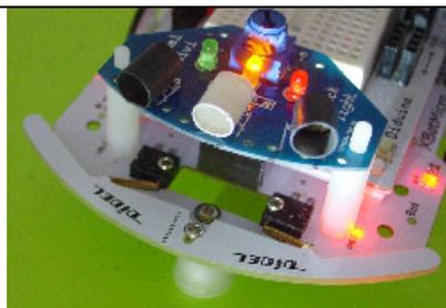
Le montage différentiel filtre l'éclairage d'ambiance. Par contre, le réglage de la distance à la source lumineuse est assez pointu.
