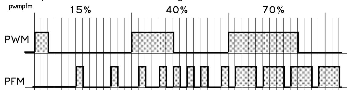
Le PFM génère des impulsions de durées constantes et se rapprochent jusqu'à 50%. Ensuite se sont des absences d'impulsions qui se multiplient. Pour qu'un mauvais moteur puisse tourner lentement, il faut que l'énergie contenue dans une impulsion isolée soit suffisante pour faire "décoller" le moteurs. Quelques millisecondes suffisent pour un petit moteur, et c'est facile à calibrer.
