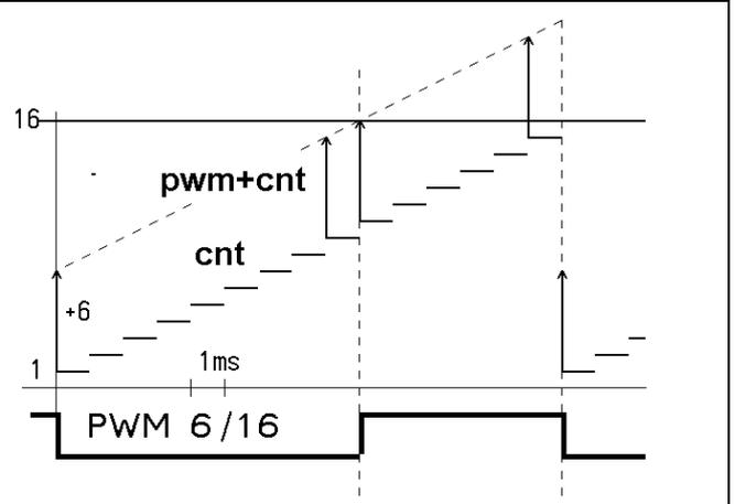
Que se passe-t-il si la valeur pwm donnée est supérieure à 16? Le signal est continuellement à "1", il n'y a pas besoin de saturer.
