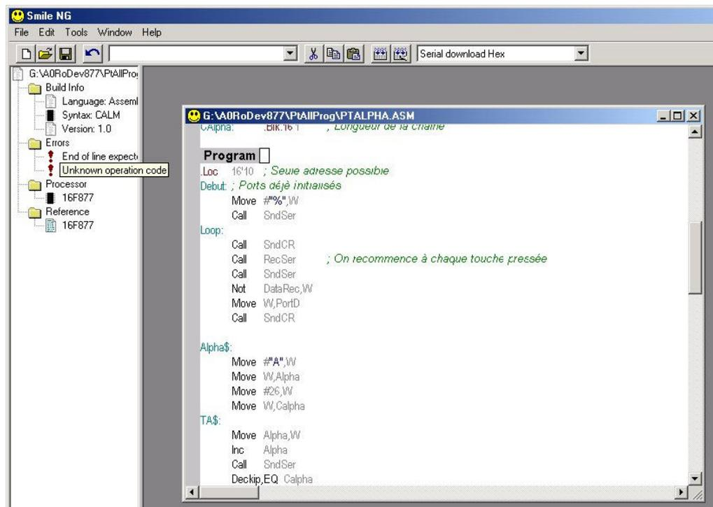
Si l'erreur est dans un fichier inséré, il est en général ouvert. Il faut alors corriger et sauver, et naturellement retourner au programme source pour retenter un assemblage. Après correction d'une erreurs, il n'est pas nécessaire de détruire le message d'erreur de la ligne suivante. Un nouvel assemblage nettoie le tout et resigneale les erreurs. Les itérations de correction sont donc très rapides.
