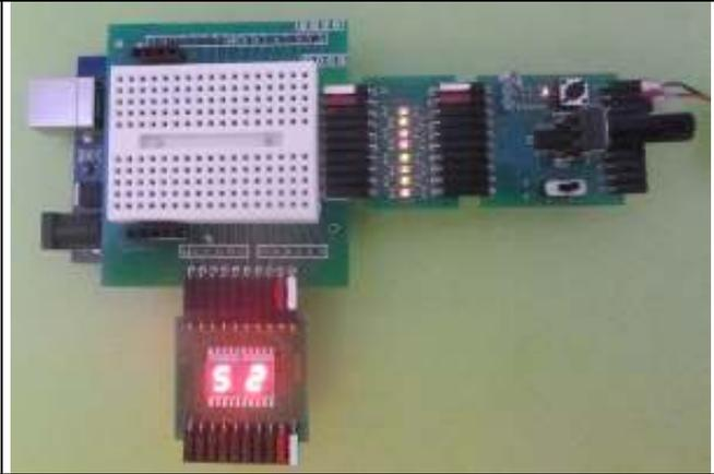
Le programme qui copie le PortK (la position du pot est convertie en binaire par un processeur local) sur le PortK2 (affichage 8 bits) peut être écrit avec un minimum d'instruction de copie des champs de bits.
