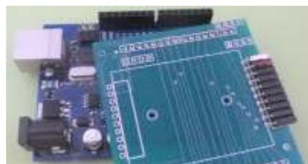
La solution proposée par Didel est le shield ArduKi, que l'on installe sur une carte Arduino compatible, et qui permet ensuite de travailler avec tous les kidules existants. Un deuxième port 8bits est possible, prévu pour un microdule d'affichage ou l'entrée d'un mot de 8 bits.
