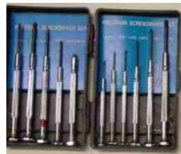
Les outils indispensables sont un jeu de tournevis, un petit marteau, une perceuse et quelques mèches. A défaut de perceuse, un perçet suffit si on travaille le bois. Pour les trous précis (engrenages), il faut avoir un ami qui a le bon outillage.
