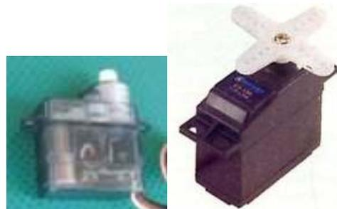
Il y a malheureusement une multitude de prises avec des ordre différents pour les 3 fils. Didel est compatible Futaba/Graupner. Se tromper dans les fils peut être destructeur !
