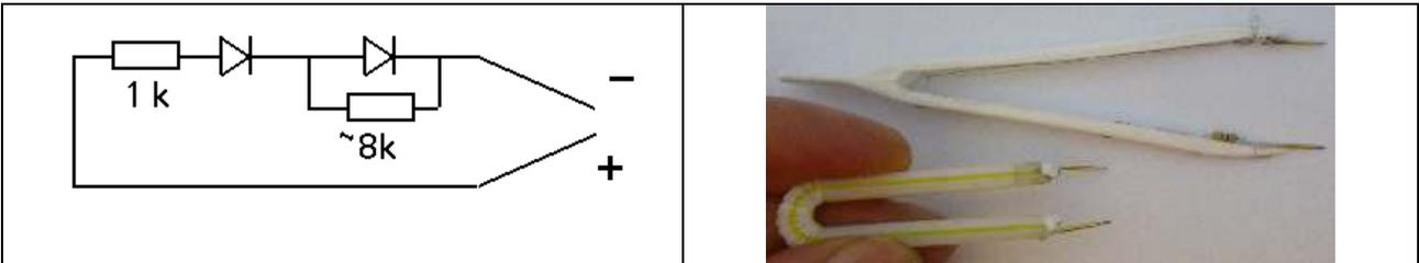
Ce montage allume les deux leds si la tension est supérieure à  $\sim 3.3V$ . Le courant consommé est de 1 mA à 3V. Le calcul des résistances est expliqué dans le complément ci-après. L'utilisation de pointes élastiques facilite le toucher.
