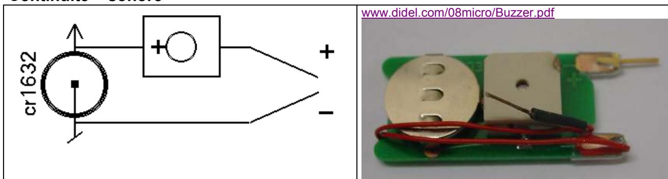
Un buzzer actif basse tension doit être utilisé. Il est polarisé. Le courant est relativement important (xx mA) Le son est maximum si la résistance du conducteur est inférieure à 50 Ohm. Il diminue ensuite jusqu'à 250 Ohms.
