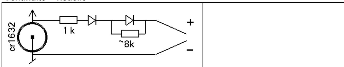
Les leds s'allument si le courant passe. La chute de tension entre les pointes définit l'intensité lumineuse. Une résistance de 0 à 2k Ohm est évaluée. Ce n'est pas un bon testeur de continuité, du courant va presque toujours passer entre deux ponts.
