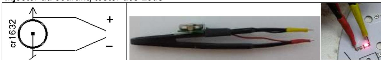
Une pile CR1632 a une résistance interne de 100 à 400 Ohm. On peut l'utiliser sans protection comme source de courant pour allumer des leds ou faire tourner un moteur "solaire" (résistance supérieure à 30 Ohm) Très pratique pour vérifier la polarité des Leds. Si la pile est court-circuitée, elle se décharge rapidement, et reconstitue une bonne partie de sa tension après qq minutes. Déchargée trop rapidement, elle gonfle.
