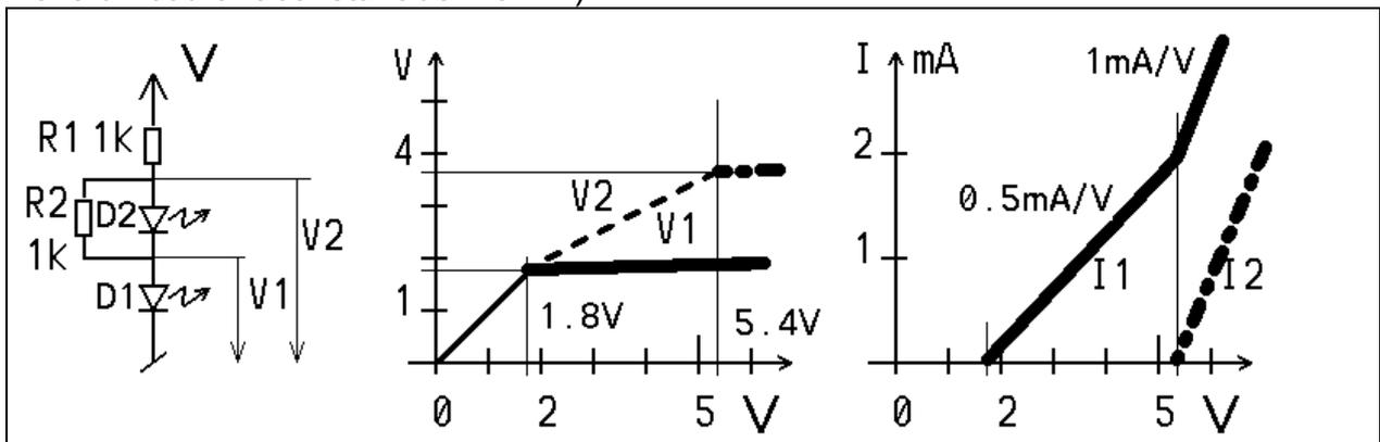
La diode 2 s'allume progressivement à partir de 5.4V, et visuellement, on voit bien la différence entre 4 piles alcalines bien chargées (6.2V) et des piles plates. On voit aussi la chute de tension si le robot a des des pointes de courant, par exemple quand les moteurs démarrent.
