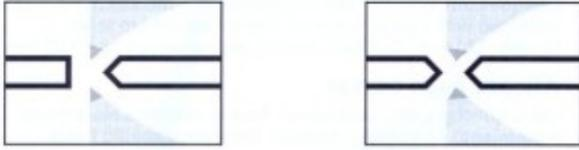
Il faut une pince coupante plate 15° pour électroniciens, et ne l'utiliser que pour couper des fils de cuivre. La photo de droite montre ce qui arrive avec de l'acier.
