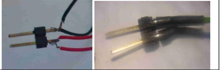
Le premier problème est donc de réaliser une soudure fiable sans que la chaleur ne déforme le plastique.
