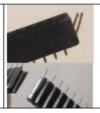
Les circuits imprimés sont équipés de connecteurs mâles ou femelles. Un circuit avec les connecteurs de polarité inverse s'installe facilement à califourchon (piggy back)
