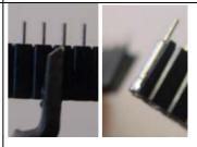
La meilleure solution est la scie plate 0.3mm ou la scie à découper un peu trop encombrante, avec une lame fine.
