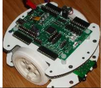
Le Wellbot2 utilise le processeur du Kidule2550, mais les ports sont attribués aux capteurs et moteurs et il n'y a que quelques lignes prévues pour des extensions, en particulier pour un affichage avec 64 Leds bicolores. Les moteurs pas à pas permettent un déplacement précis. L'accu rechargeable par le connecteur USB permet un fonctionnement de plusieurs heures.
