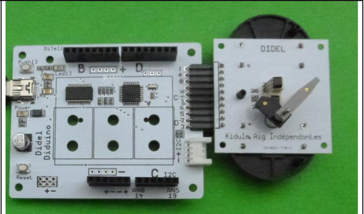
Des capteurs de hall ont été ajoutés avec résistance de protection. connecteur broche 9 pour les heures, 7 pour les minutes. Cet interface montre la nécessité d'être attentif aux noms des signaux avant de commencer à programmer:
