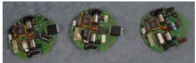
Cyclopes en 1994, processeur HC11 et caméra linéaire
