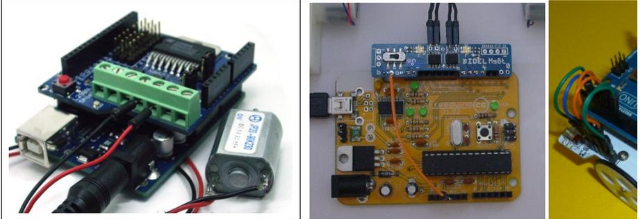
D'autres shields utilisent les pins 5,6, 9,10. Sur le XBot, le câblage est libre, mais le câblage sur les pins 4,5,6,7 est facilité
