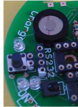
Souder dessous les connecteur pour les capteurs de distance (broche de 0.7mm). Aligner au mieux.
