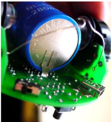
Souder l'accu. Le plus est du côté de l'interrupteur. Activer l'interrupteur. Les deux leds proches doivent s'allumer (une seule si l'accu est déchargé).
