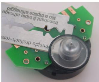
Souder les moteurs. Les PCB sont symétriques. Pour insérer les roues, mettre une cale de 0.2 à 0.4mm pour garantir la distance au circuit imprimé (papier épais, lame de rasoir). Ajouter éventuellement une goutte de colle sur l'extrémité de l'axe.
