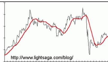
Evidemment, à la première mesure, la moyenne ne peut pas se calculer sur des données précédentes. Le setup remplit la table avec une première mesure du capteur. Si on initialise la table avec des zéros, ce que le compilateur fait par défaut, il faut attendre 4 ou 8 mesures avant d'avoir rejoint les bonnes valeurs
