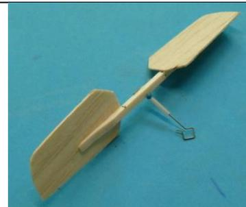
La position des pales de l'hélice est dessinée sur le longeron et les surfaces du longeron sont chanfreinées par rapport aux pales. Coller; on voit que les surfaces des pâles sont perpendiculaires entre elles. Il est important que les deux pales aient à la fin un angle de 45 degrés par rapport au plan de l'hélice.
