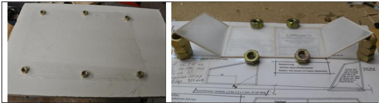
Disposez le film sur une surface propre et plate et si nécessaire maintenez tendu avec quelques poids. Toutes les pièces ne sont couvertes que d'un côté. Après collage, posez les parties entoilées avec le film contre un plaque de bois ou carton, et coupez la feuille tout autour avec un fer à souder pas trop chaud.
