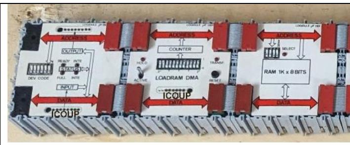
Le premier est une interface d'entrée-sortie ICOUP, à l'adresse sélectionnée par le bloc de commutateurs. Les deux suivants permettent au Nova de charger la mémoire à partir d'une adresse donnée sur 16 commutateurs. La décomposition de la mémoire 1K en 16 blocs de 64 ne semble pas logique.
