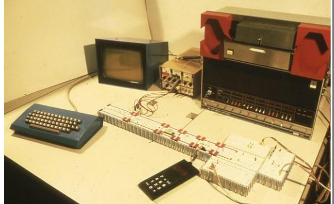
La photo montre un Nova1200 de 1972 (~10 kF) avec son lecteur de bandes papier (2kF). Le moniteur vidéo et un clavier semblent évoquer le rêve d'interaction.
