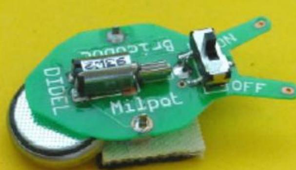
L'idée avec le **Milpat**, développé pour le Festival Robotique de l'EPFL en 2009, a été d'utiliser une bonne vieille peau de phoque militaire avec ses poils inclinés de 4mm. La vibration verticale du moteur induisait un mouvement linéaire parfait, avec un frottement permettant des pentes de 10%. Un circuit imprimé portait le moteur 4mm, la pile CR2032 de 3V et l'interrupteur. Le "robot" était très stable et facile à personnaliser.
