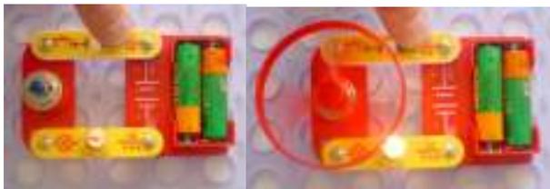
Si l'expérience 4 a été bien comprise, on en déduit que la résistance du moteur arrêté est plus faible que quand il tourne. C'est vrai. Si on pouvait le faire tourner encore plus vite avec un moteur extérieur, il fournirait du courant comme une dynamo et pourrait recharger l'accu !
