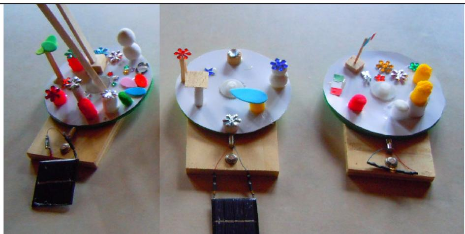
Un carrousel doit tourner lentement. L'entraînement direct par un moteur avec un réducteur de 200 et plus pose un problème d'encombrement et de prix. Un entraînement par courroie élastique implique une grande poulie. Notre solution est d'utiliser un CD entraîné par un moteur pager (sans masselotte) avec sur son axe de 0.8mm un tube caoutchouc qui augmente le moins possible son diamètre. Le rapport de réduction avec un axe de 0.8mm est alors de 150, soit environ un tour/seconde.
