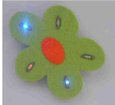
Le courant passe dans les diodes du + vers une sortie du processeur, numérotée 0 à 7.
