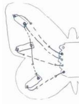
Pour chaque diode, une fois positionnée, piquer horizontalement dans l'épaisseur du feutre pour aller vers le module Lm8.
