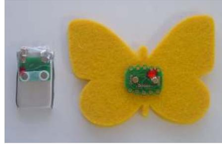
La position des LEDs et leur couleur doit être réfléchi à l'avance. Le câblage doit éviter tout risque de court-circuit. On évitera donc de devoir croiser des fils. Si on veut un effet lumineux précis, il faudra programmer des tables en tenant compte de l'ordre des LEDs. Avec le logiciel standard, les alternances de lumière amusent même si elles ne sont pas absolument cohérentes avec le motif dessiné.
