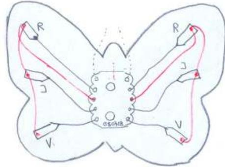
Pour coudre, il faut du fil de cuivre nu ou étamé de 0.15mm de diamètre, max 0.20mm. On le trouve facilement dans du fil électrique souple, dont on enlève l'isolant. Le fil d'installation ne convient pas. Prendre du cordon pour lampe, rasoir, chargeur. Sur la photo, le gros fil a des brins de 0.20, le fil bleu des brins de 0.15. Préparer suffisamment de brins de 25-30cm de longueur.
