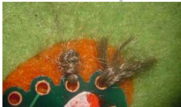
La technique avec du fil de cuivre de 0.15 et plusieurs tours dans les boucles est presque utilisable sans fer à souder. Mais il faut bien serrer les boucles, et quand même finir par trouver un fer pour les mauvais contacts !
