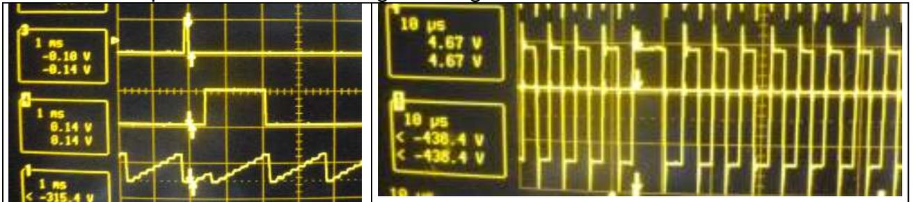
La 2e photo évalue le temps utilisé par le processeur à chaque interruption. Le programme principal oscille une pin avec la durée minimale incluant la boucle, soit environ 3 microsecondes. cette durée est augmentée à chaque interruption de 3 us, (la machine d'état appelle une dizaine d'instructions à chaque passage. La mesure permanente de la distance coûte 3 us toutes les 100 us. Connecter plusieurs capteurs coûte chaque fois 3 us, en répétant la fonction.
