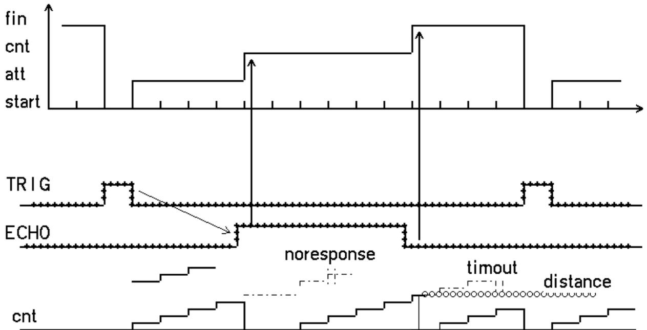
Pour aider à la mise au point, il est très utile de pouvoir afficher 6 bits pour visualiser l'état ou le compteur. Le port Kidule et le microdule DA8 sont utilisés dans la photo suivante, qui montre le compteur en dessous de signaux Trig et Echo.
