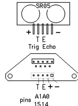
Une impulsion sur Trig déclenche l'envoi de 8 impulsions à 40 kHz et active le signal Echo, qui est désactivé quand l'écho revient (min 2cm 100 us). La durée d'un aller retour pour une distance de 25cm est environ 1,3 ms.
