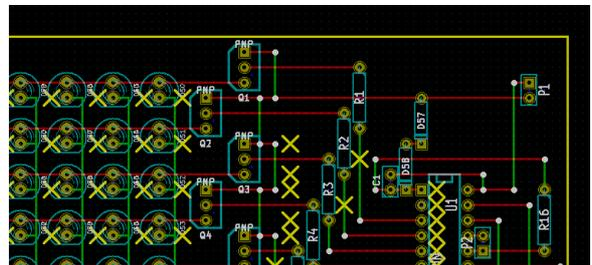
Une fois le plan dessiné, il suffit de l'imprimer sur du papier, à l'échelle exacte, de le découper et de le plastifier avec des bandes de plastique transparent collant, en laissant quelques millimètres de chaque côté en vue de le coller sur la plaque.
