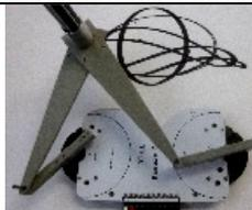
**Kidule 2 aiguilles.** Deux aiguilles indépendantes sur le même axe permettent des jolis mouvements et des comportements inspirés de montres multifonctionnelles. Des capteurs permettent le référencement initial de position.
