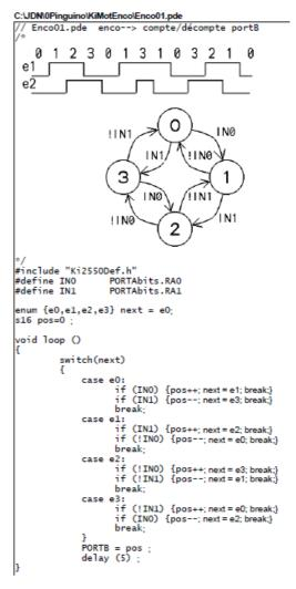
Comme exemple d'encodeur, le "Keith mini mechanical encoder" est 10mm de large et donne 48 transitions par tour. Lié à une roue de 30mm la resolution est de 2mm, acceptable pour un petit robot.
