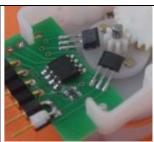
Le moteur Rome et son encodeur RomEnco de Didel et Solarbotics www.didel.com/mot/RomEnco.pdf convient bien pour expérimenter avec un microcontrôleur. Le MiniRomEnco est en développement.
