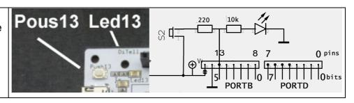
Un poussoir est tout aussi utile, et manque sur les cartes Diduino (il y en a deux sur les cartes MSP). Sur le Diduino2, ce poussoir est câblé sur la pin 13 avec des résistance de protection.
