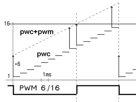
Le programme est simple et a différentes variantes. Toutes les ms on répète l'intérieur de la boucle for pour préparer **pwc**. On fait ensuite le calcul qui décide si on doit activer la Led.
