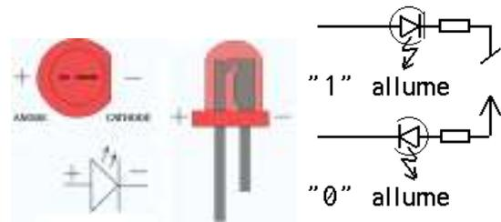
Avec Arduino, on doit déclarer la pin et l'activer-désactiver. C'est le programme Cligno0.ino dans lequel on règle le délai en millisecondes (ms).
