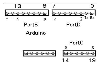
Le microcontrôleur du Diduino, un AVR Atmega-328, a 3 ports , B, C, D. Ces ports de 8 bits ont des entrées/sorties numérotées de 0 à 7, mais ils sont parfois incomplets.
