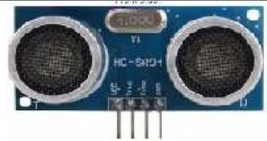
Une impulsion sur Trig déclenche l'envoi de 8 impulsions à 40 kHz et active le signal Echo, qui est désactivé quand l'écho sonore revient. Le min de distance est 2cm (~100 us), le max ~3m. La durée d'un aller retour pour une distance de 25cm est environ 1,4 ms. Si la distance est trop grande, le signal reste à 1 pendant 0.2s, ce qui est fort gênant. La directivité est très mauvaise. Il faut s'écarter de 20 degrés d'un petit obstacle pour que l'écho vienne de derrière l'obstacle.
