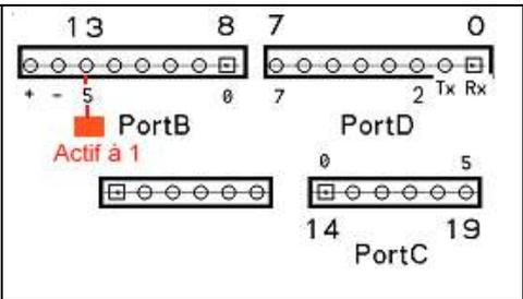
Pour accéder aux pins, on a le choix entre les fonctions Arduino, ou l'accès direct aux bits des registres
