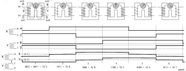
Les bits 0-2 et 1-3 du portD commandent le moteur gauche et le bits 4-6 et 5-7 le moteur droit. La séquence hexa 3-B-8-C-4-7 correspond aux 6 excitation actives et ont été déclarées dans le fichier Base.asi sous les noms Pos1.. Pos6.
