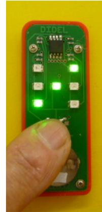
Les leds sont câblées sur des pins reliées à l'intérieur du processeur sur les bits du registre d'entrée/sortie appelé port B On voit sur le schéma que la correspondance est
