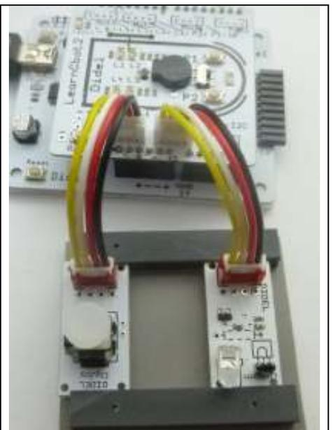
Si vous êtes un fan de grove, joystick et diode infrarouge existent. Vous pouvez même utiliser un capteur IR par réflexion, en ignorant le récepteur.
