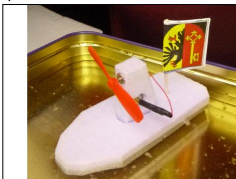
Il faut encore un gouvernail. Avec un cure-dent et un drapeau, le gouvernail est sous le vent de l'hélice. S'il y a quelques cm de tirant d'eau, le gouvernail peut être dans l'eau. Il faut alors trouver du plastique mince et une colle qui résiste. Qu'est-ce qui ira le mieux?
