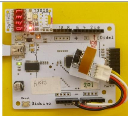
On voit que la boucle for a été supprimée, car l'affichage ne défile pas; il dure 3ms. Avec la suppression des rebonds, on est toujours limité à 100 transitions par secondes.
