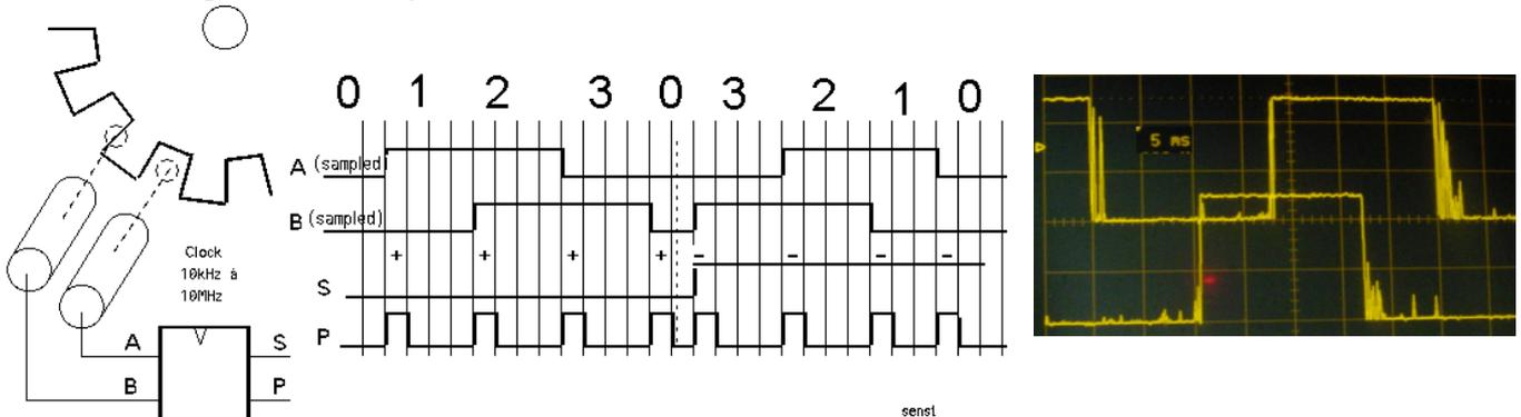
Le contrôleur échantillonne les signaux A et B et prend la décision d'incrémenter ou décrémenter un compteur selon l'état précédent. L'algorithme le plus simple s'appuie sur le graphe des états.
