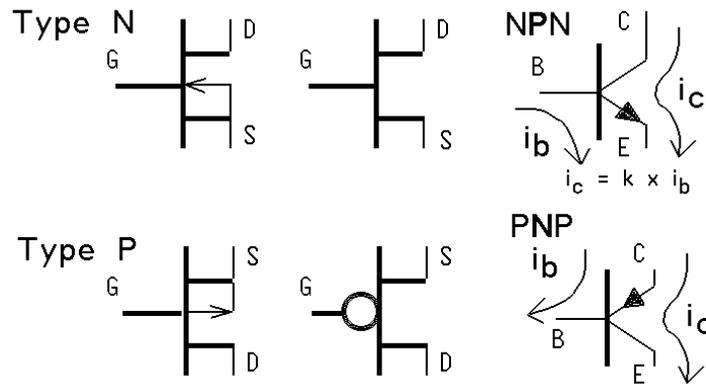
Le paramètre important en robotique, pour commander un moteur, est la résistance interne  $R_i$  du transistor. Les transistors ne sont pas parfaits, c'est pour cela qu'ils chauffent ! Si la résistance interne est de 2 Ohm et que vous commandez un moteur 2 Ohm, le 50% de la puissance est perdu dans le transistor, et il va chauffer autant que le moteur. L'idéal est que la résistance interne soit moins d'un dixième de la résistance externe.
