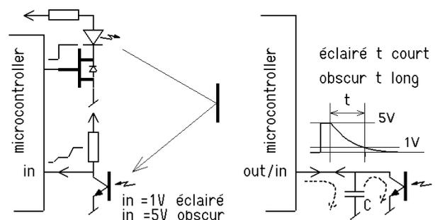
Le premier schéma est un diviseur de tension, lu par une entrée analogique sur le processeur. Le second schéma mesure un temps de décharge.
