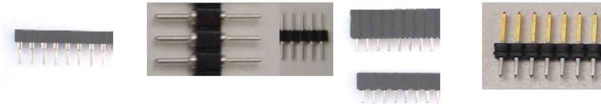
Les barrettes mâles se laissent bien couper. Pour les barrettes femelles, il faut une scie fine. Avec une pince coupante à bec fin on abîme facilement le dernier contact. Le plus sage est de couper au milieu de la douille suivante, et de recouper le plastic ou limer pour faire propre.
