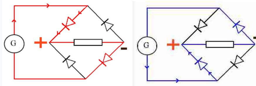
Pour redresser un courant alternatif, il faut de préférence 4 diodes en pont de Graetz, @H5 que l'on trouve dans des circuits appelés ponts redresseurs @H6
