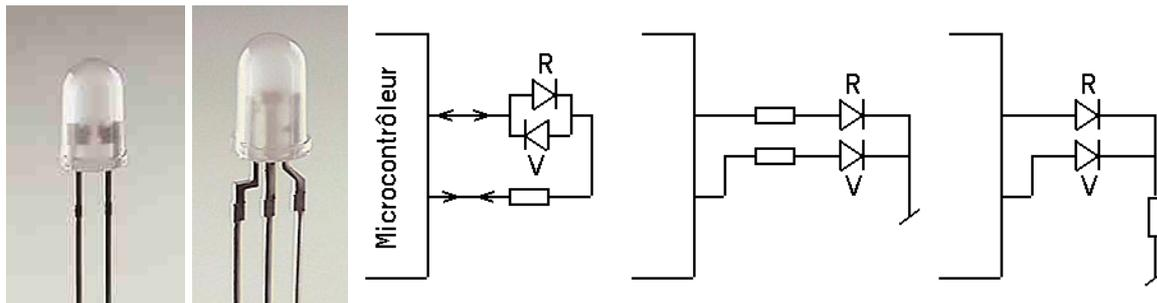
Les diodes bicolores à 3 fils sont formées de deux diodes avec une cathode commune (ou une anode commune). Il faut de préférence deux résistances, si on n'en met qu'une, l'intensité va varier selon que l'on a une ou deux diodes allumées. Branchées sur une sortie de microcontrôleur, elles ont l'avantage que les 2 diodes peuvent être allumées simultanément. Avec une LED bicolore à 2 fils, il faut alterner rapidement le courant pour voir du jaune, mélange du vert et du rouge.
