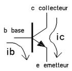
Attention la diode entre la base et l'émetteur va brûler si le courant est excessif.
