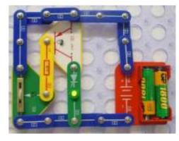
L'utilisation d'une paire de transistors permet d'avoir une amplification très grande, donc des courants très faibles en entrée pour commander le courant de sortie. Dans le montage ci-contre, une résistance de 100 kOhm charge le condensateur de 470  $\mu$ F. Pour que la tension aux bornes du condensateur atteigne les 0.7V nécessaires pour que ce transistor conduise (et le suivant aussi), il faut un temps t=RxC = 5 secondes, ce que l'on constate.
