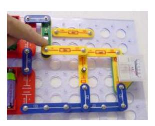
Le condensateur a deux applications principales : branché en parallèle comme ci-dessus, il fait réservoir et fournit du courant si la tension baisse. On trouve donc des condensateurs vers l'alimentation des processeurs, mémoires et autres circuits intégrés qui ont des brusques besoins pour des impulsions de courant.
