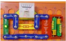
Attention, les diodes lumineuses du jeu sont spéciales, la résistance limitant le courant est à l'intérieur. Une LED brûle si le courant n'est pas limité par une résistance.
