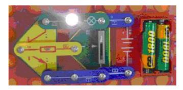
Le transistor est donc un amplificateur. Faisons un détecteur d'obscurité qui allume une lampe quand l'éclairage est trop faible.
