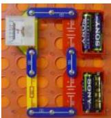
La boîte contient un potentiomètre, dont la valeur n'est pas marquée. Le principe du potentiomètre est d'avoir un frotteur qui se déplace le long de la résistance. Entre une extrémité et le frotteur, la résistance varie.
