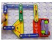
Modifions le schéma pour qu'une résistance de 100 kOhm fasse conduire le transistor et allume la LED, et la LDR dévie une partie du courant vers le moins, donc réduit le courant dans la base. Si c'est éclairé la résistance est faible, il y a moins de courant pour faire conduire le transistor, la LED s'allume.
